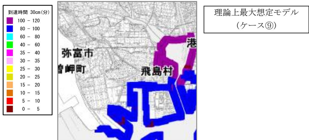
図 5. 4-5 (1) 愛知県 (2014)における飛島村沿岸の津波到達時間 (津波高+30cm)
