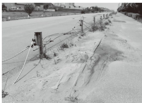
液状化で地面から砂が噴出した様子
